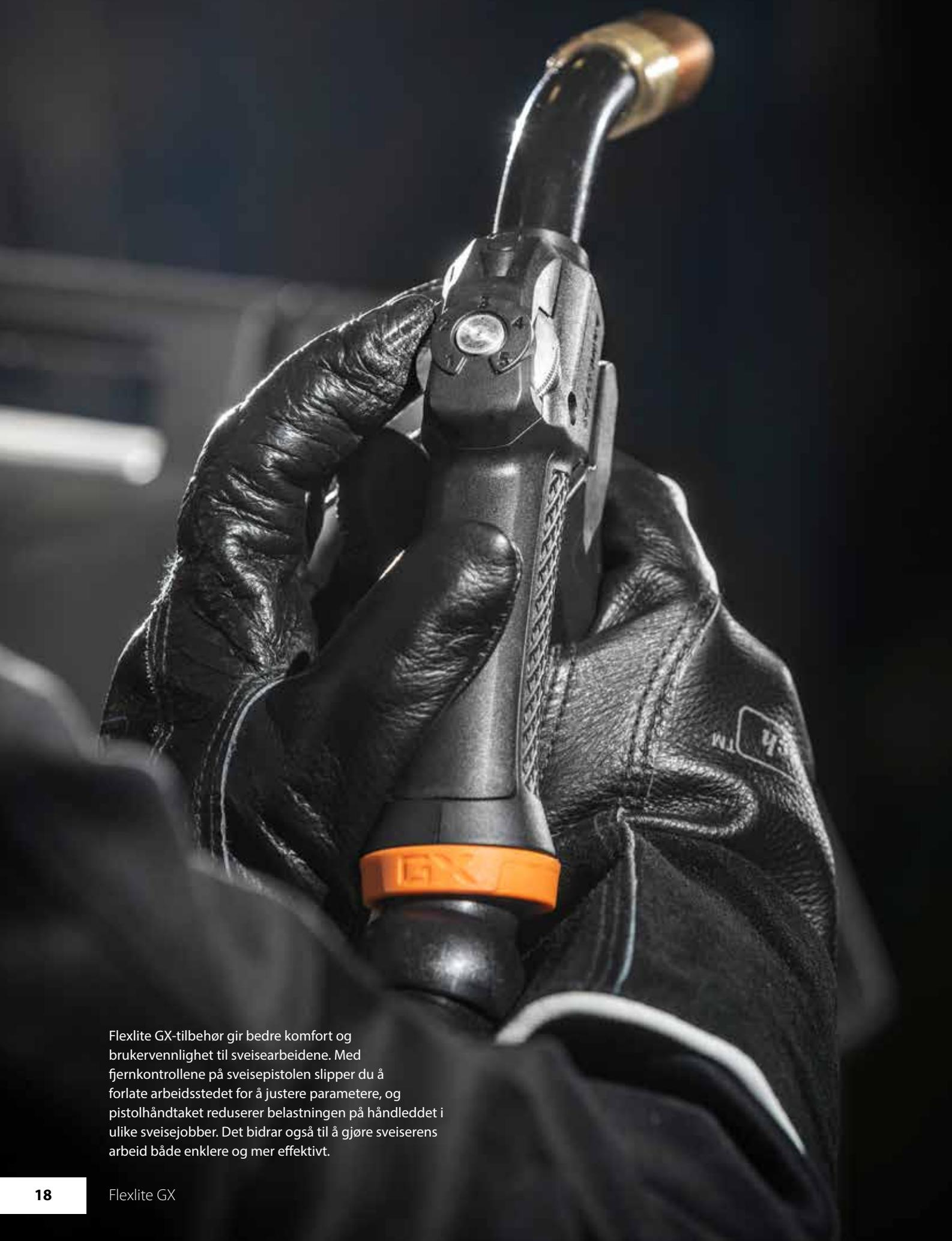
Flexlite GX-tilbehør gir bedre komfort og brukervennlighet til sveisearbeidene. Med fjernkontrollene på sveisepistolen slipper du å forlate arbeidsstedet for å justere parametere, og pistolhåndtaket reduserer belastningen på håndleddet i ulike sveisejobber. Det bidrar også til å gjøre sveiserens arbeid både enklere og mer effektivt.
