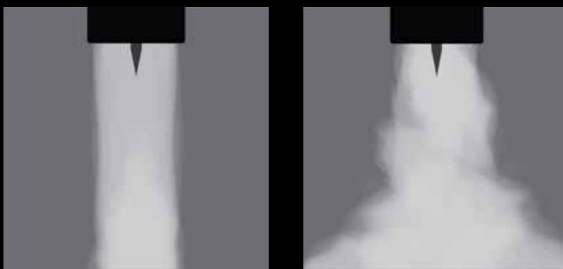
Illustrasjonen til høyre viser en svært turbulent strøm med dårlig skjerming og høyt gassforbruk.
