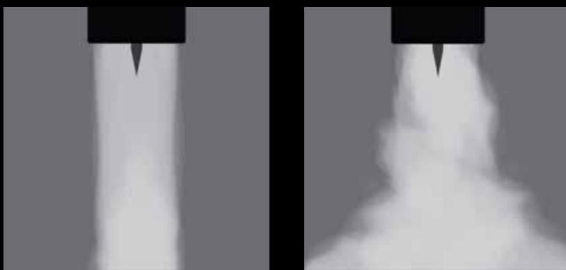
Illustrasjonen til høyre viser en svært turbulent strøm med dårlig beskyttelse og høyt gassforbruk.
