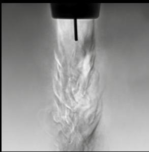
Dekkgasstrømmen er avgjørende for sveisekvaliteten. Normalt er dekgassen usynlig, men med Schlieren-bildeteknologi er det mulig å observere den faktiske gasstrømningen. Dette viser hvordan utformingen av Flexlite GX -sveisepistolene og forbruksdelene legger til rette for den laminære gasstrømningen og bedre gassdekning.
