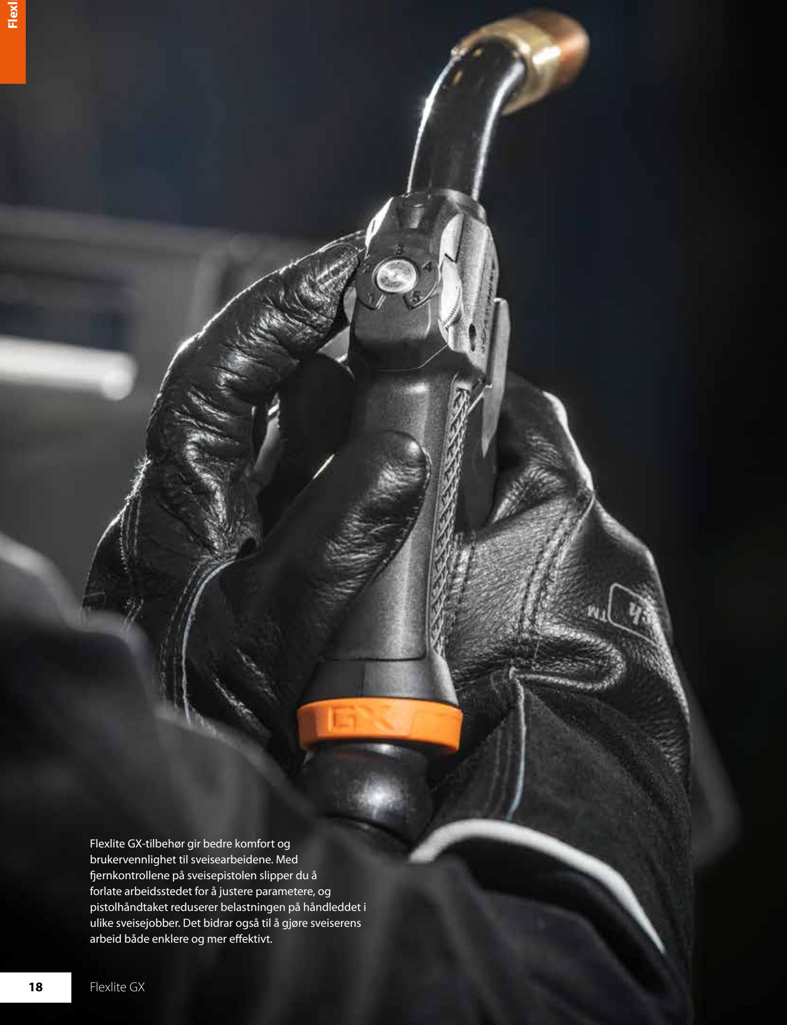
Flexlite GX-tilbehør gir bedre komfort og brukervennlighet til sveisearbeidene. Med fjernkontrollene på sveisepistolen slipper du å forlate arbeidsstedet for å justere parametere, og pistohlåndtaket reduserer belastningen på håndleddet i ulike sveisejobber. Det bidrar også til å gjøre sveiserens arbeid både enklere og mer effektivt.
