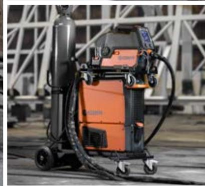
*El carro del alimentador de alambre de cuatro ruedas cuenta con un diseño de "conexión rápida" que permite acoplarse fácilmente a las fuentes de potencia estándar de X5 FastMig, proporcionando un almacenamiento y un transporte seguros y en el nivel del suelo.*
