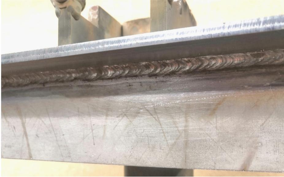
**图 3.**脉冲 MMA 焊接仰焊角焊缝（焊接位置 PD）。基材 5 毫米结构钢 S355 和填充材料 3.2 毫米碱性焊条。焊接电流 130 A，脉冲频率 1.5 Hz。考虑到焊接应用，飞溅量最小。
