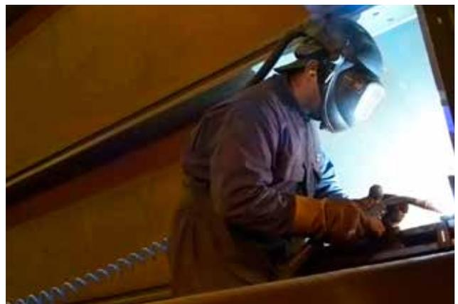
Les solutions d'apport d'air externe sont idéales lorsque des gaz de soudage peuvent s'accumuler et déplacer l'air respirable.
