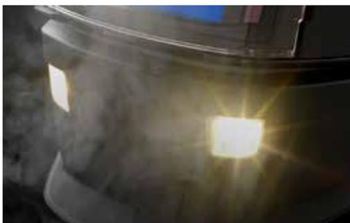
**Pour le travail en environnement à faible luminosité**, les modèles de la série Gamma GTH3 XFA intègrent des lampes de travail à LED de 70 lumens, alimentées directement par la batterie rechargeable du PAPR. Les lampes peuvent être allumées et éteintes à partir de la commande montée sur le casque.
