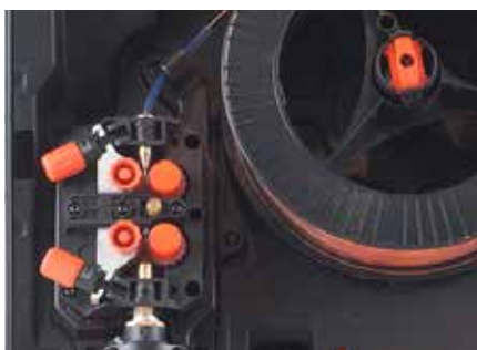
Kempact 253/323 -malleissa on nelipyöräinen DuraTorque-langansyöttömekanismi.
