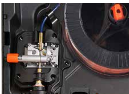
Kempact 251 -malleissa on kaksipyöräinen GT02C-langansyöttömekanismi.
