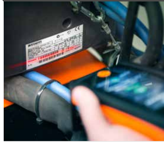
ArcValidator RC registra tutti i dati individuali del processo di convalida per il successivo trasferimento al software per PC.
