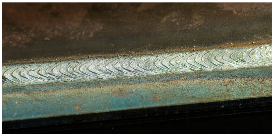
Рисунок 4. В диапазоне полукруглой дуги процесса WiseSteel производится чередование переноса по короткой дуге и струйного переноса. Это приводит к образованию чешуйчатой поверхности сварного шва.
