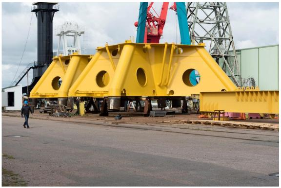
Последняя партия из 30 переходных элементов для платформ шельфовых ветряных мельниц на ветряной ферме «Беатрис» в Шотландии ожидает отгрузки на пирсе Levator. Большие элементы весом 150 тонн соединяют поддерживающие трубы, которые уходят в морское дно, и сам ветряной двигатель турбины. Эти элементы должны отлично функционировать в суровых погодных условиях Северного моря. Во время диагностического тестирования Levator производила по одному переходному элементу каждые пять рабочих дней.
